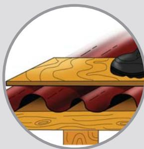
Se recomienda no caminar directamente sobre la plancha. Colocar tablones apoyados en los soportes.
