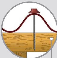
Las fijaciones deben ser sobre los listones y en la parte alta de la onda.
